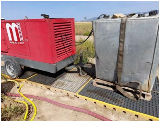
Fig. 1. Generador y bidón de recogida del agua contaminada.
