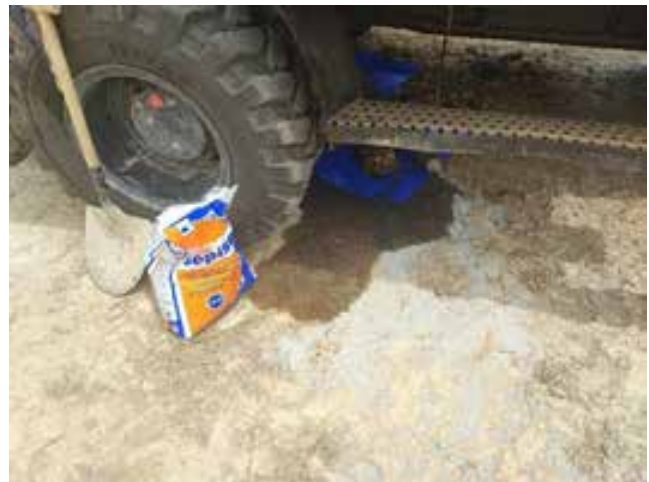
Fig. 1. Máquina con derrame causado por avería y aplicación de sepiolita.
