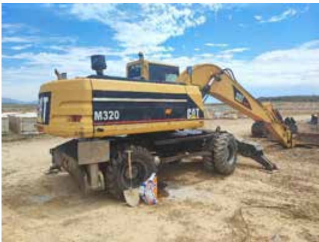
Fig. 1. Máquina con derrame causado por avería y aplicación de sepiolita.
