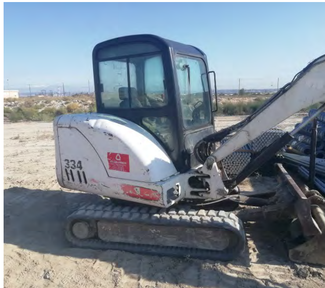
Figura 1: Maquinaria sin extintor.
