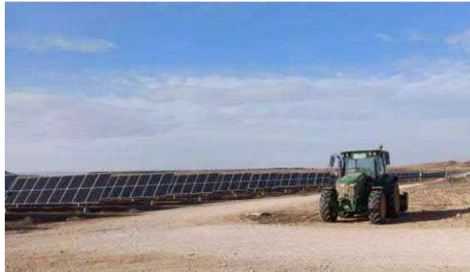
Imagen 5. Tractor utilizado para el control de la vegetación que crece en el interior de la planta fotovoltaica
