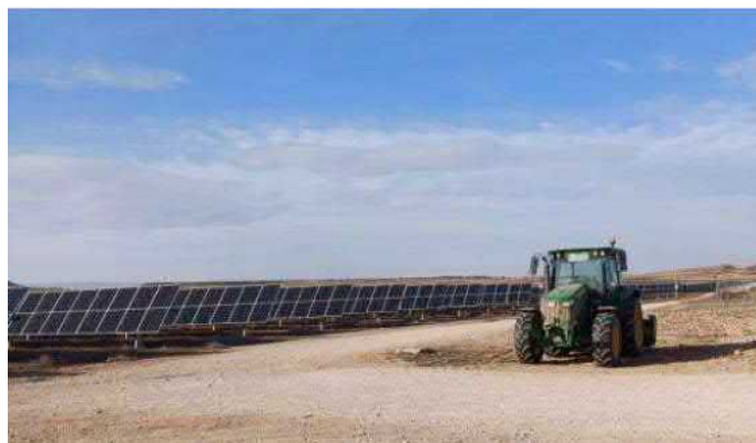
Imagen 3. Tractor utilizado para el control de la vegetación que crece en el interior de la planta fotovoltaica
