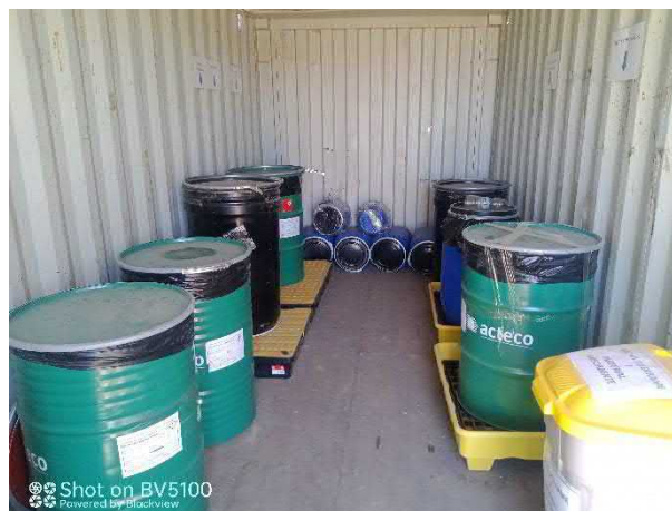
Imagen 25. Depósitos homologados adecuadamente identificados situados en el interior del punto limpio para el depósito temporal de residuos peligrosos
