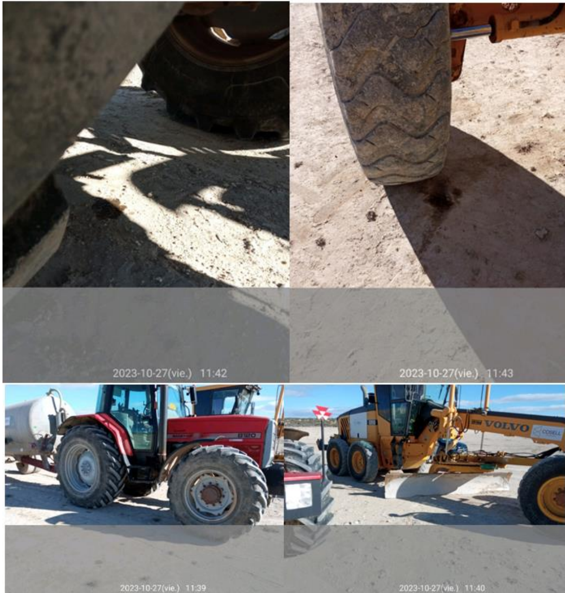
Ilustración 7. Máquinas estacionadas fuera de la zona de parking y sin plástico protector debajo, con pequeño vertido debajo de cada una.
