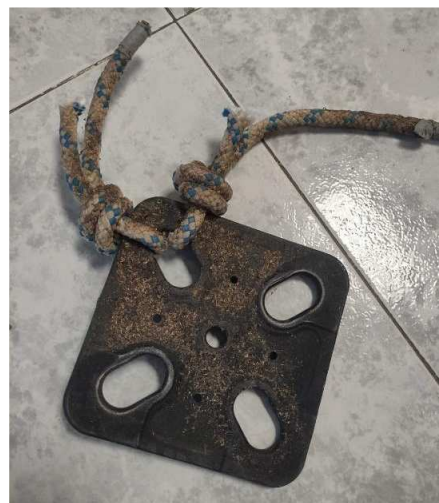
Unión corta sistema flotante. Con suciedad incrustada.
