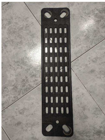
Unión larga sistema flotante. Con suciedad incrustada.
