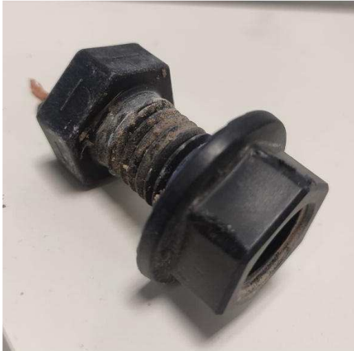
Conjunto tornillo + tuerca sistema flotante. Con suciedad incrustada.
