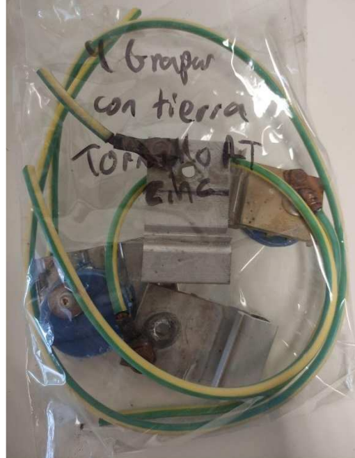
Latiguillos de tierra unidos a grapas. Terminales oxidados.
