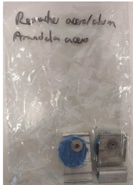
Grapas con remaches de acero/aluminio y arandelas de acero. No se han oxidado.
