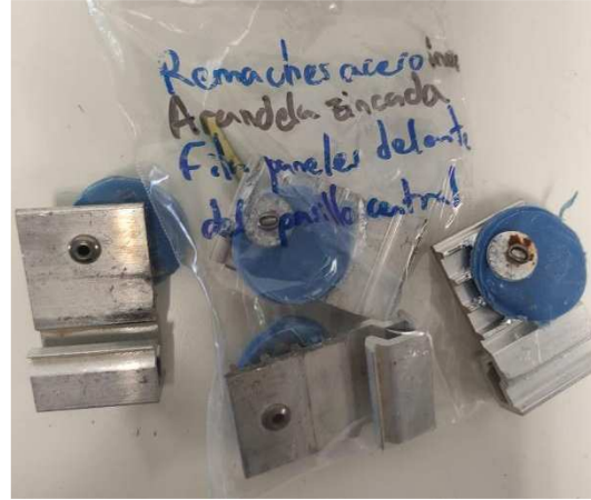
Grapas con remaches de acero inoxidable y arandelas zincadas. Se han oxidado un poco la arandela.
