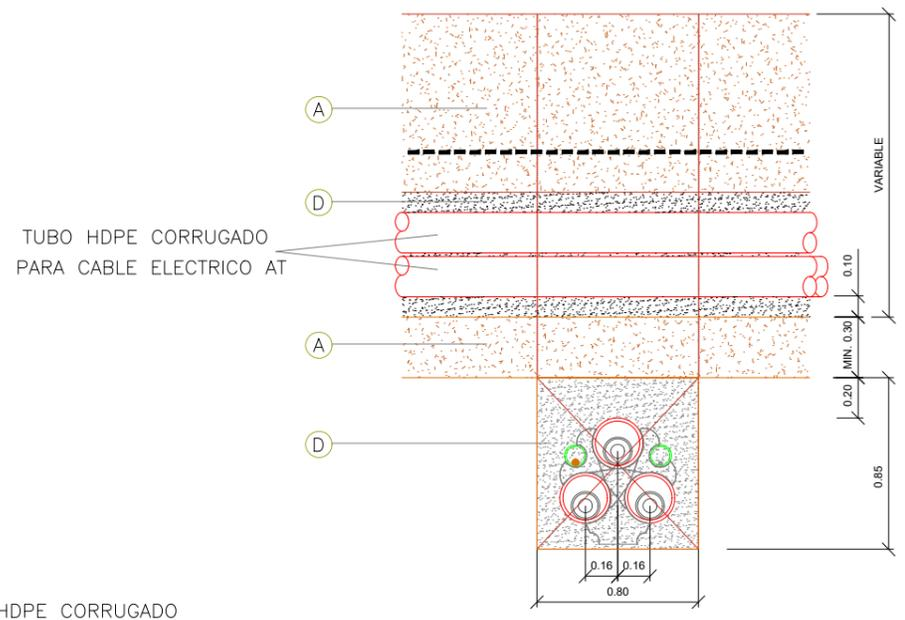
**NOTAS CRUZAMIENTO ENTRE ZANJA EN TIERRAS EXISTENTE Y ZANJA NUEVA CONTRUCCIÓN HORMIGONADA**
