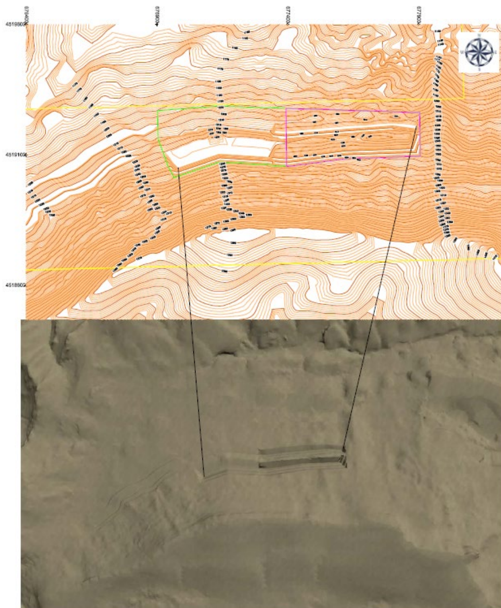
Figura 81. Hueco de explotación tras terminar la Fase V con el área restaurada de la Fase IV y simulación en-3D del hueco creado.
