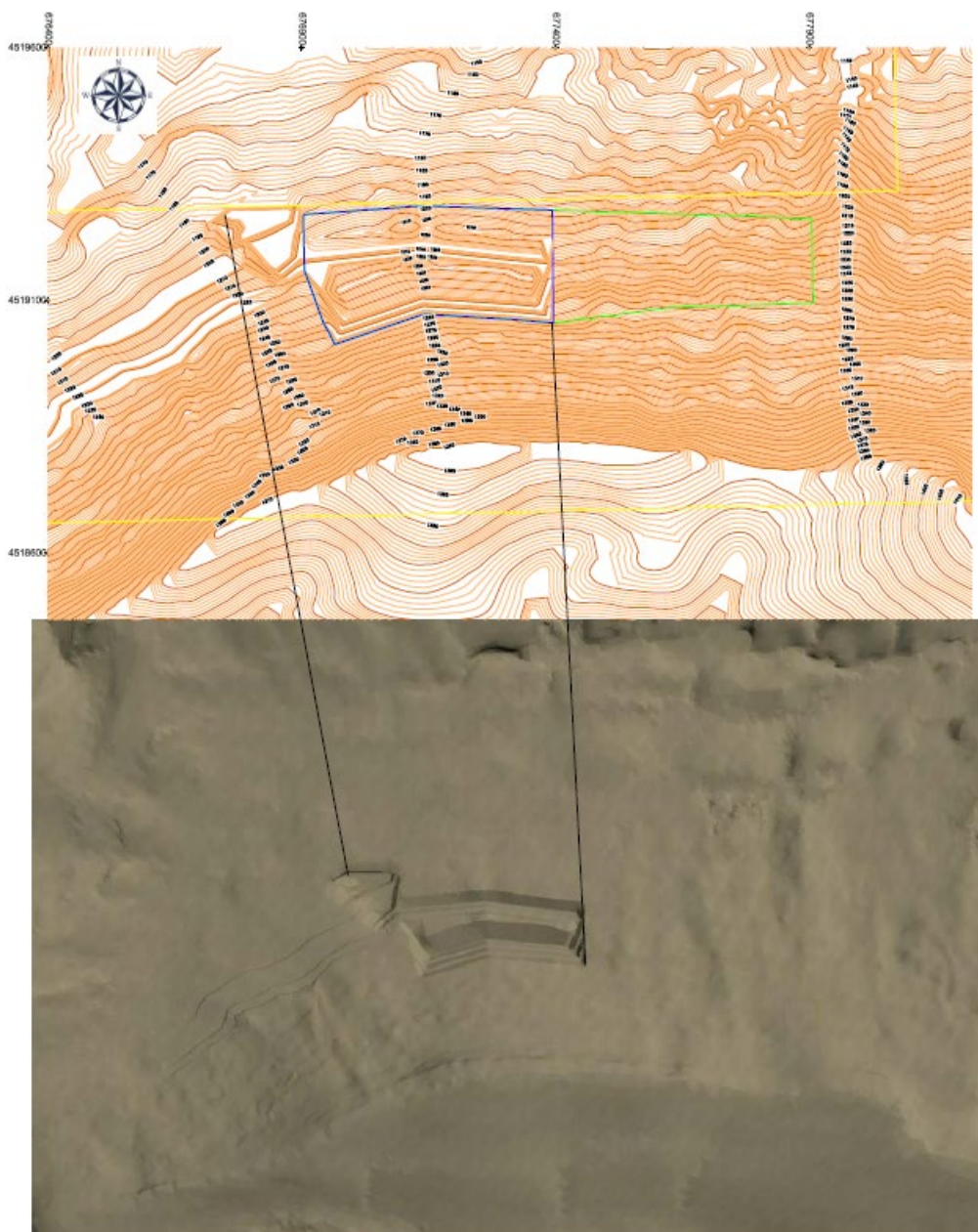
Figura 79. Hueco de explotación tras terminar la Fase IV con el área restaurada de la Zona 1 y simulación en-3D del hueco creado.
