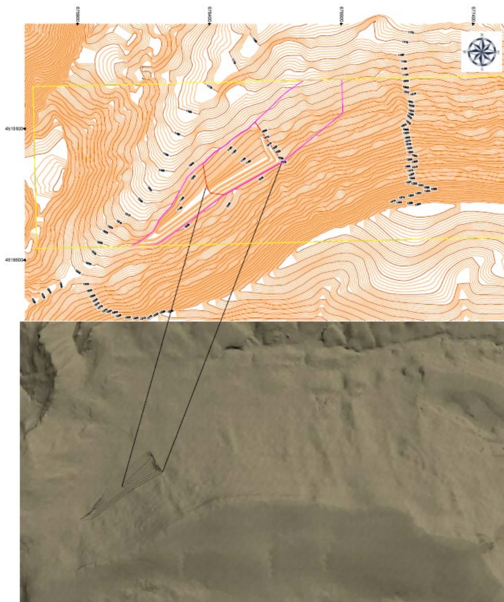
Figura 75. Fase II de explotación con hueco de explotación en color rojo y simulación 3D del hueco.
