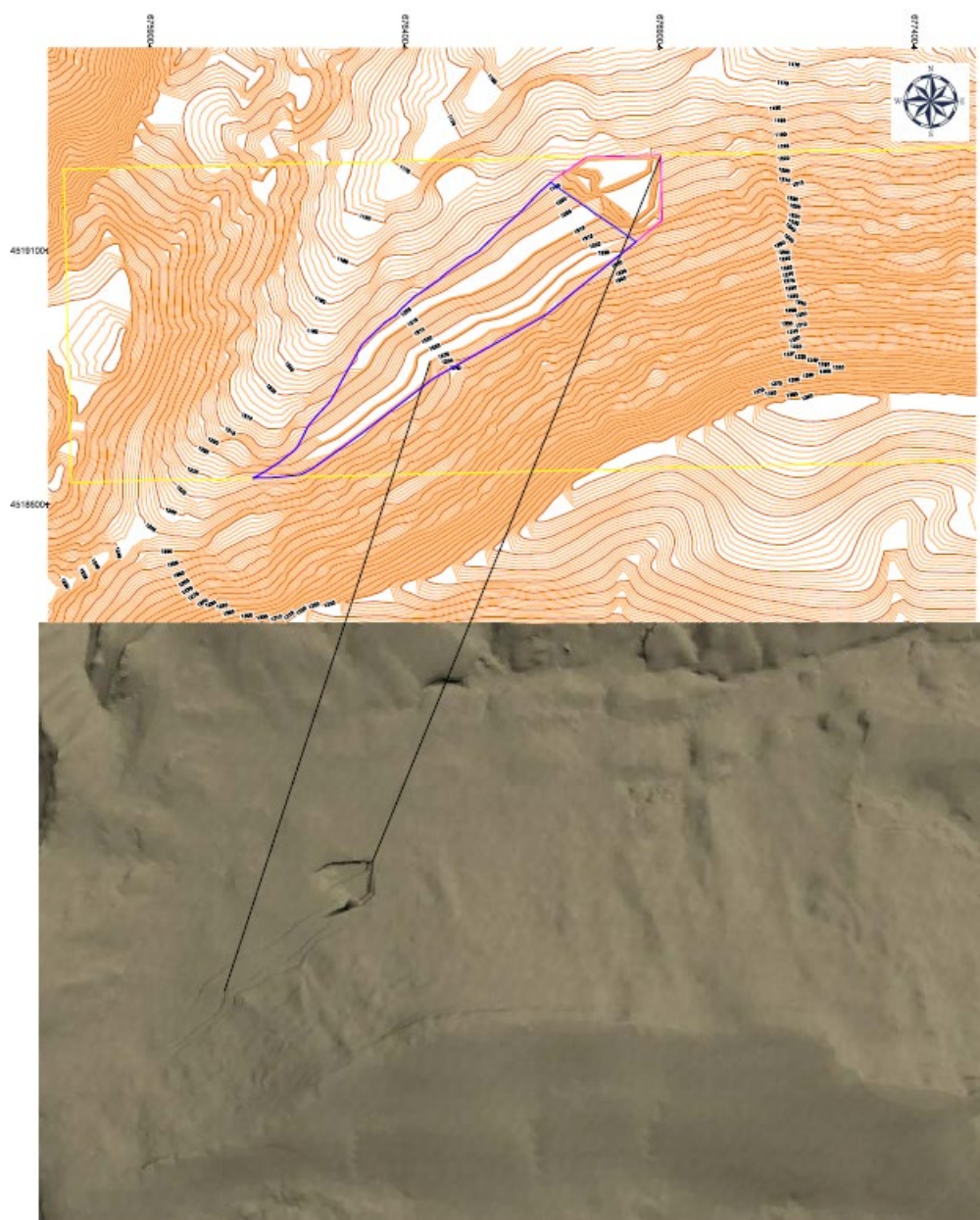
Figura 78. Hueco de explotación tras terminar la Fase III con la zona restaurada de las Fases I y II, indicada con la línea azul, y simulación en-3D del hueco creado.
