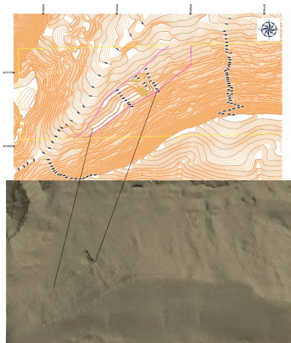
Figura 77. Hueco de explotación tras terminar la Fase II con la zona restaurada de la Fase I, indicada con el perímetro en color verde, y simulación en-3D del hueco creado.
