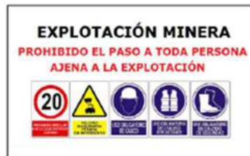
Fig Señalización de seguridad a colocar en el acceso de la explotación
