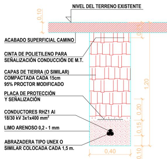
**DETALLE 2 - CONDUCCIÓN SUBTERRÁNEA M.T. DOBLE CIRCUITO DIRECTAMENTE ENTERRADA**
