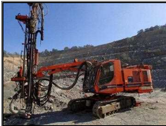
Fig. 5 : Perforadora a rotopercusión. Fuente: ViE.
