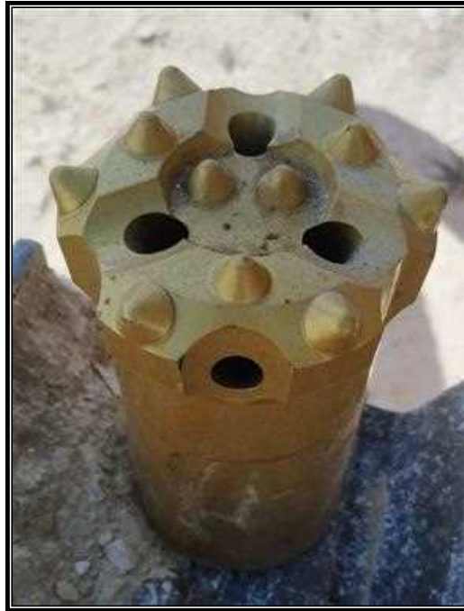
Fig. 4 : Broca de botones. Fuente: MINERVOL.
