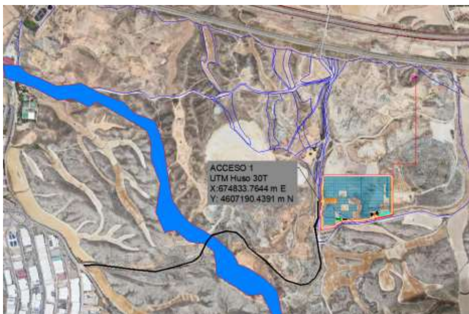
Figura 4: Acceso al Parque Solar FV.
