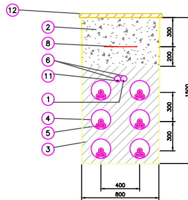
LAMT 11/15 kV-TRAMO SUBTERRÁNEO PFV SABIÑÁNIGO I y IV, II,III,V,VI ZANJA PARA SEIS CIRCUITOS MEDIA TENSION EN ZONA DE CARRETERA
