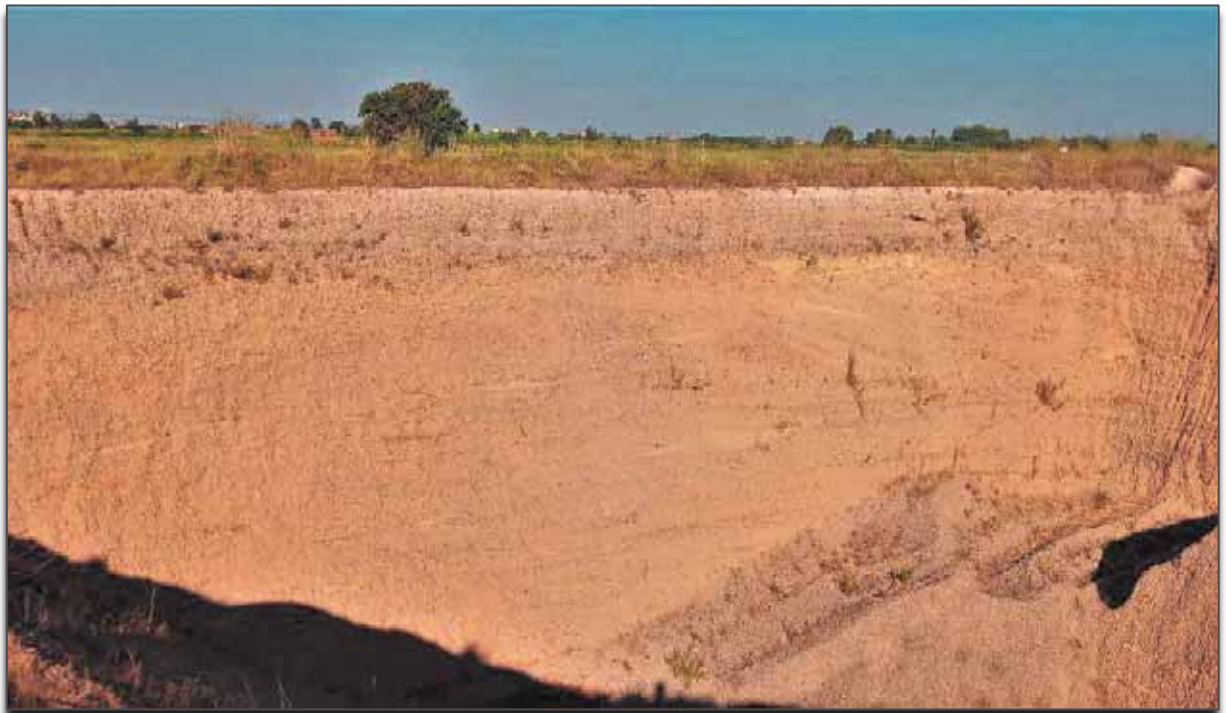
Figura nº 12. Frente de explotación en la CE ALTOS PEÑES en el que se aprecia el aspecto general de las gravas de las terrazas medias, en esta zona se aprecian estratificaciones cruzadas planares y en surco.
