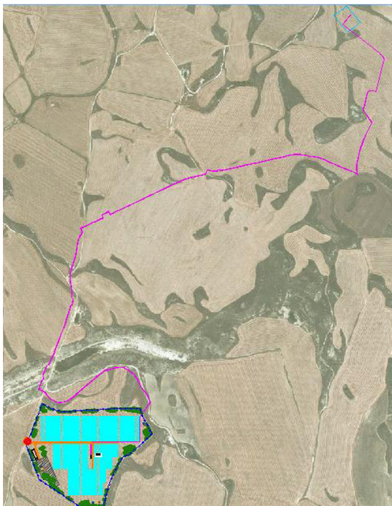
Ilustración 2: vista general del módulo de generación fotovoltaico y su línea de evacuación
