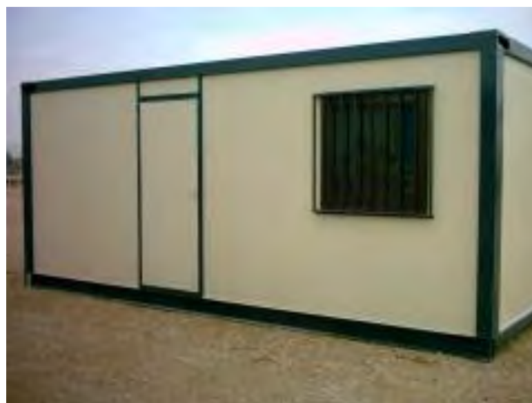
Imagen 15: Caseta provisional de Obra
