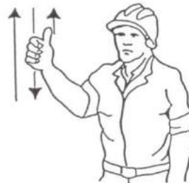
4 Levantar el aguilón o pluma lentamente
