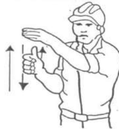
4 Levantar el aguilón o pluma lentamente
