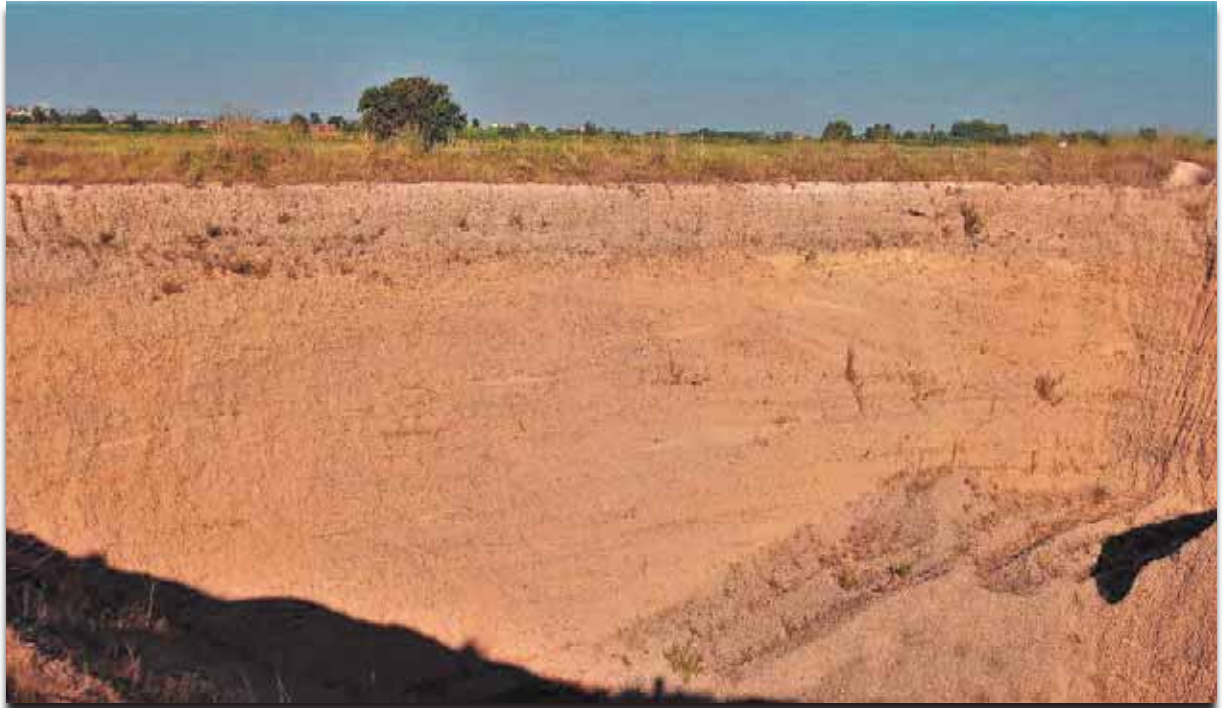
Figura nº 16. Frente de explotación en la C.E. ALTOS PEÑES en el que se aprecia el aspecto general de las gravas de las terrazas medias, en esta zona se aprecian estratificaciones cruzadas planares y en surco.
