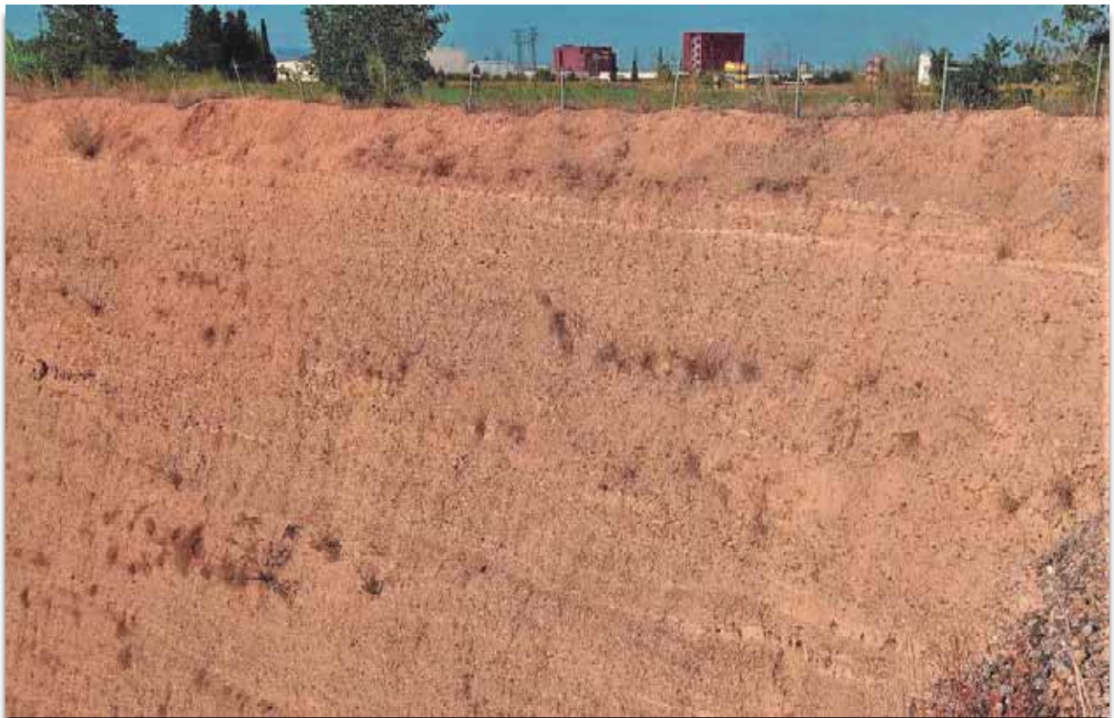
Figura nº 17. Detalle de las gravas con arenas de las terrazas medias en la cantera LAURA nº 349 (parcialmente coincidente con la C.E. ALTOS PEÑES).
