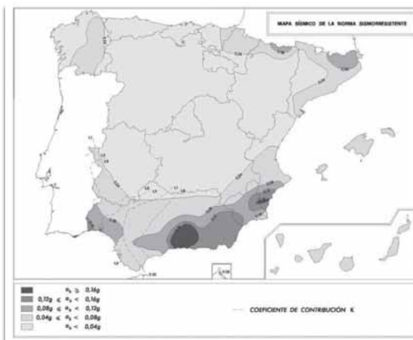
Figura nº 45. Mapa de Peligrosidad Sísmica. Fuente. RD 997/2002, Norma de construcción sismorresistente: parte general y edificación (NCSR-02)
