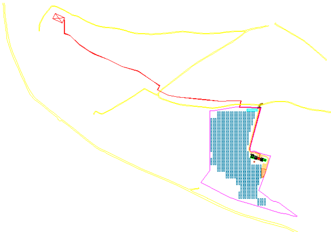
Figura 6: Layout de la Planta Solar FV
