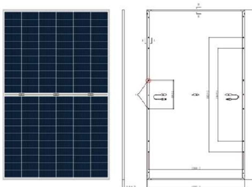
**Figura 7: Dimensiones del Módulo**
