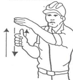
4 Levantar el aguilón o pluma lentamente
