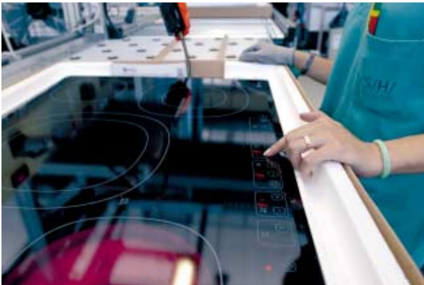
Montaje de placas vitrocerámicas.
