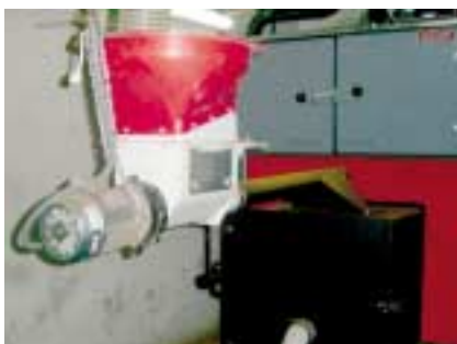
Detalle de la tolva de alimentación
