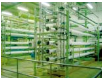
Detalle de la planta de ósmosis.
