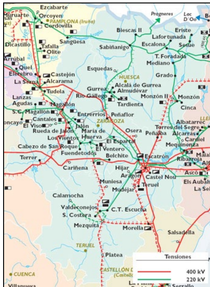
Red de transporte de energía eléctrica en Aragón (REE). 2011
