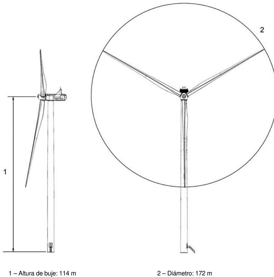
Figura 1: Alzado Aerogenerador
