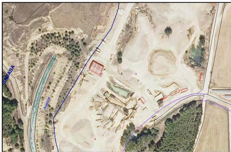
**Figura nº 1.** Detalle de la instalación industrial que procesará las gravas arenas a extraer en la cantera "ELEVACION-3".
