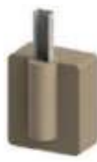
Hinca con pre- taladro
