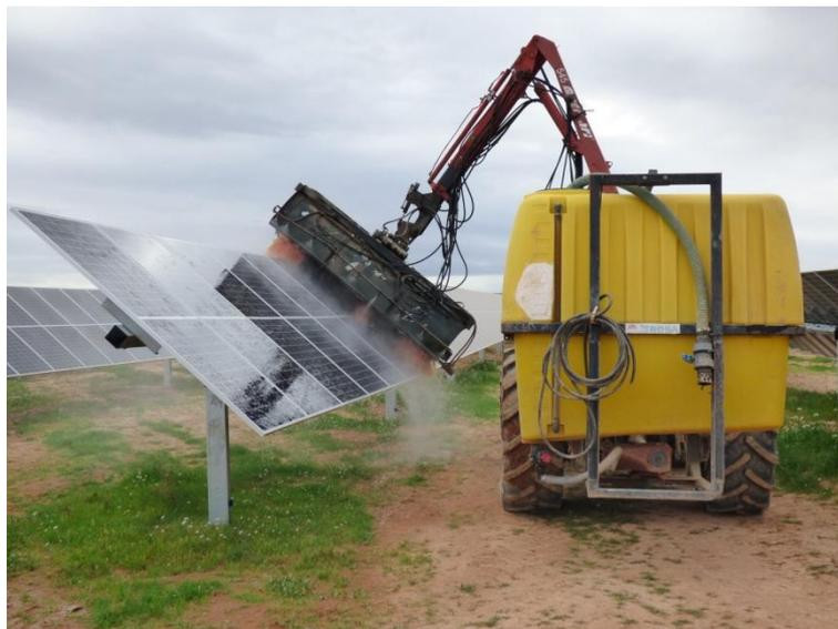
Figura. 3. Limpieza de paneles solares mediante un rodillo acoplado a un tractor
