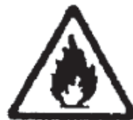
RIESGO DE INCENDIO MATERIAL COMBUSTIBLE
