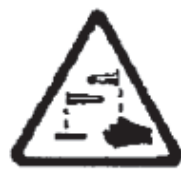
RIESGO DE CORROSION
