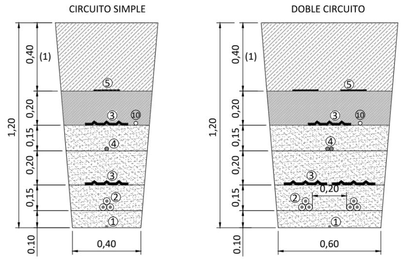
(1) - Cuando la zanja discurra por terreno agrícola se incluirá una capa de 0.25 m de tierra vegetal quedando 0.35 m de material compactado mecánico.
