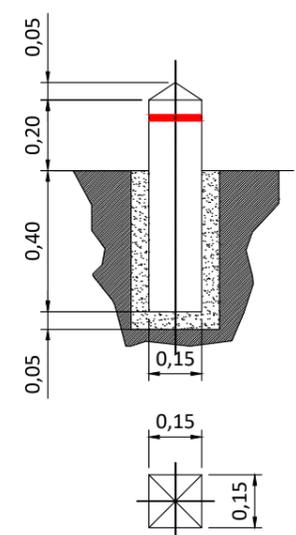
(3) - El número de franjas a señalar en el hito dependerá de los circuitos enterrados en la zanja
