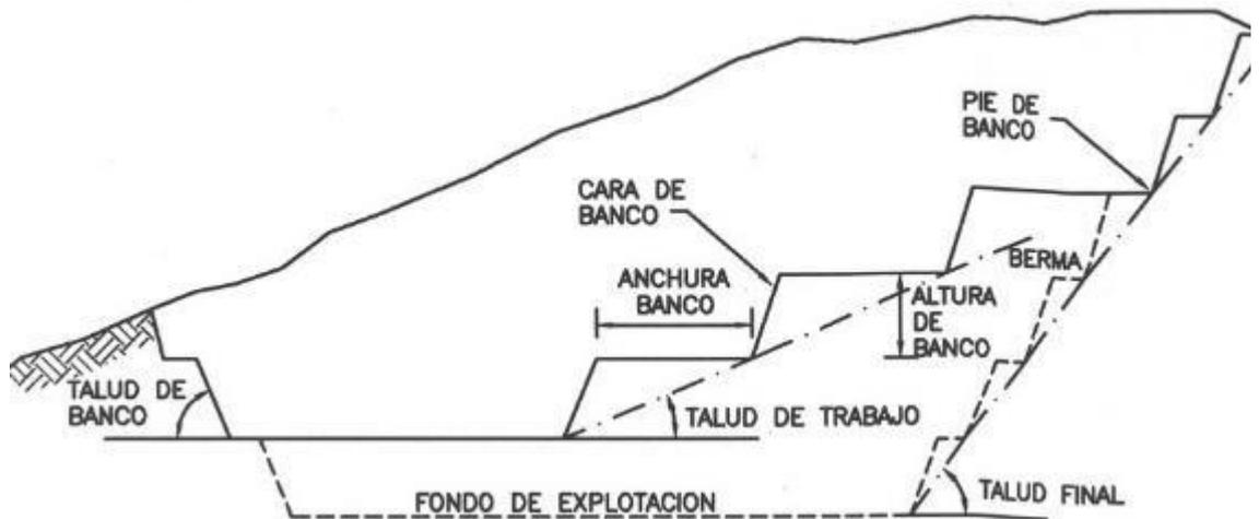
Figura 19. *Parámetros geométricos de diseño de explotaciones* (Fuente: Manual de Evolución y Diseño de Explotaciones Mineras. -M. Bustillo Revuelta, López Jimeno.).
