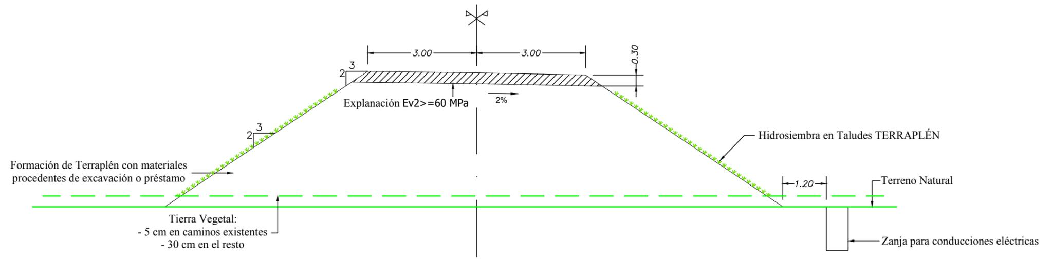
**SECCIÓN TIPO VIAL EN DESMONTE**
