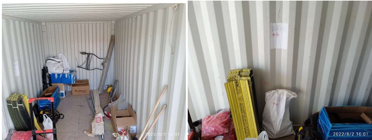
Imagen 11.- Interior contenedor punto limpio de residuos peligrosos. Saca blanca etiquetada para envases de sprays vacíos
