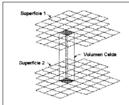
En nuestro caso, se utilizan como datos de entrada ficheros de superficies. Al solicitar los parámetros iniciales, se ha de introducir además, la Dimensión de Celda que se utilizará para crear las mallas con las que calcular el volumen. Una vez especificados los dos ficheros de superficies a utilizar, el programa calcula el volumen superponiendo las mallas generadas a partir de las superficies e informa de los resultados obtenidos.
