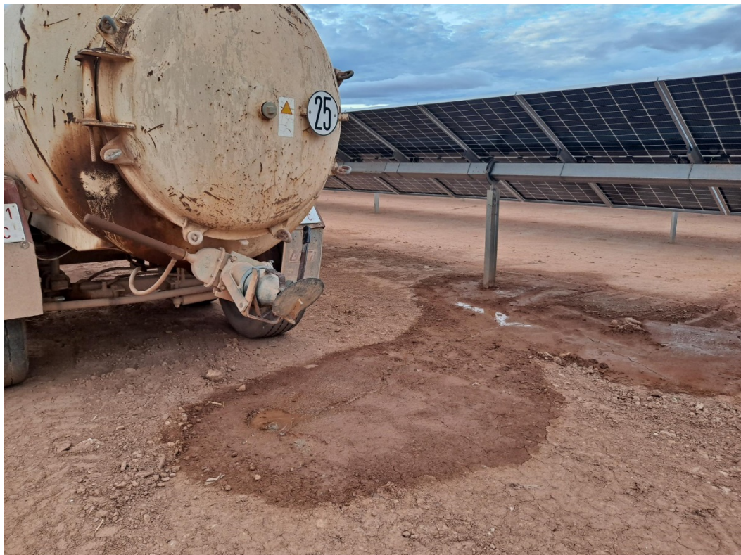
Foto 7. Pequeña fuga de agua de la cisterna de riego
