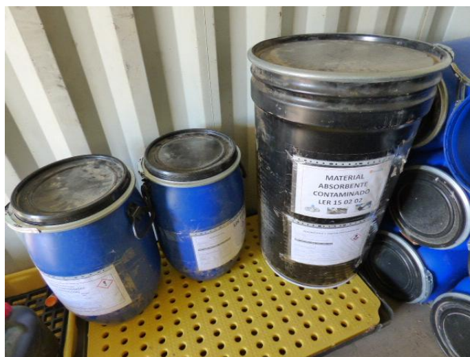
Imágenes 24 y 25: Exterior del contenedor destinado para el almacenamiento temporal de los depósitos de residuos peligrosos convenientemente identificado (fotografía de la izquierda). Depósitos homologados e identificados conforme a la normativa vigente para el almacenamiento de residuos peligrosos (fotografía a la derecha).
