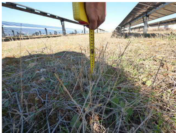
Imagen 4 Altura de la vegetación en el interior del parque fotovoltaico tras la siega de la misma
