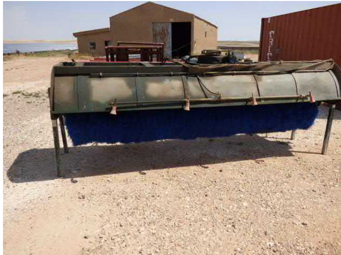
Imágenes 3 y 4: Extensión utilizada para la limpieza de paneles (izquierda). Tractor con la extensión adjunta, realizando la limpieza de paneles (derecha).
