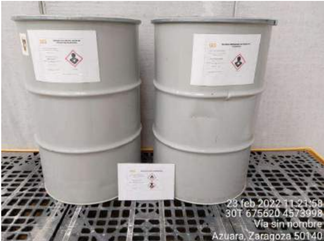
Imagen 2. Etiquetado de los contenedores de RP.
