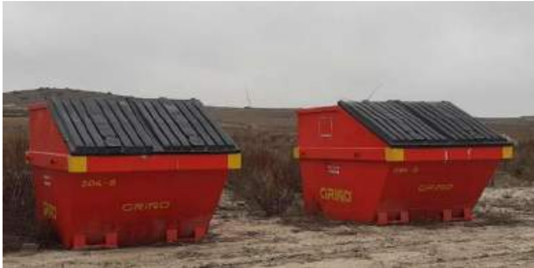
Imagen 1. Contenedores para Residuo No Peligroso con tapa.
