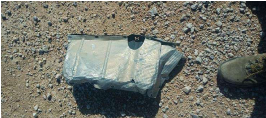
Protector térmico de un vehículo en la plataforma de uno de los aerogeneradores del PE Farlán.
