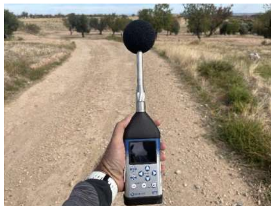
Figura 18: Sonómetro integrador modelo clase 1 SVAN 977 utilizado para la evaluación de los niveles de presión sonora en el parque eólico.
