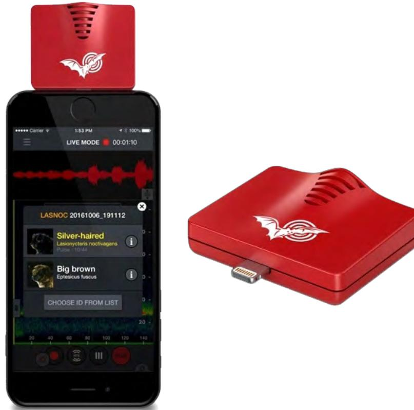
Figura 21:Detalle del dispositivo Echo Meter Touch insertado en un smarthphone con la aplicación de utilización específica. Fuente: <https://www.wildlifeacoustics.com>.
