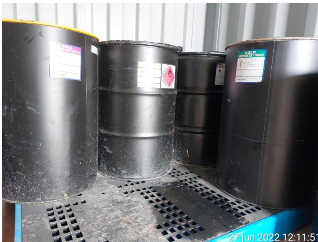
Imagen 1. Contenedores de RP sobre cubeto de contención en punto limpio de SGRE.
