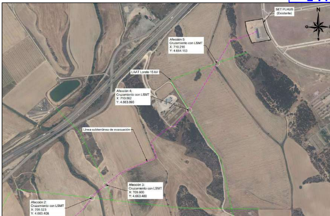
Ilustración 4: Afecciones PFV La Hoya a e-Distribución Redes Digitales – LAMT Loreto 15 kV (proximidad)
