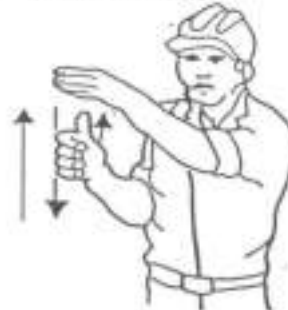
4 Levantar el aguilón o pluma lentamente
