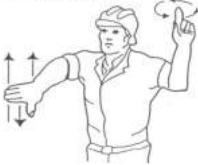
10 Bajar el aguilón a pluma y levantar carga
