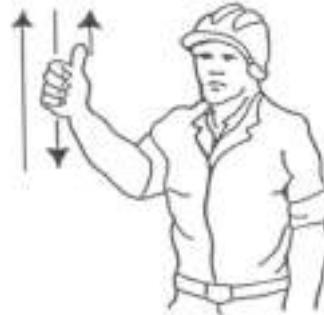
4 Levantar el aguilón o pluma lentamente
