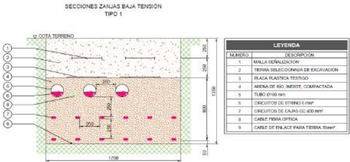
**Ilustración 1 Zanja de BT CC**
