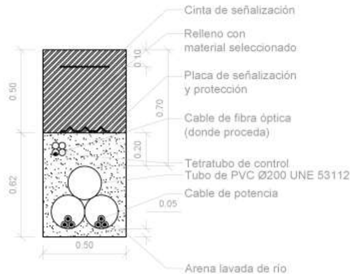
Ilustración. Zanja para tramo de LSMT entre CS y LAMT
