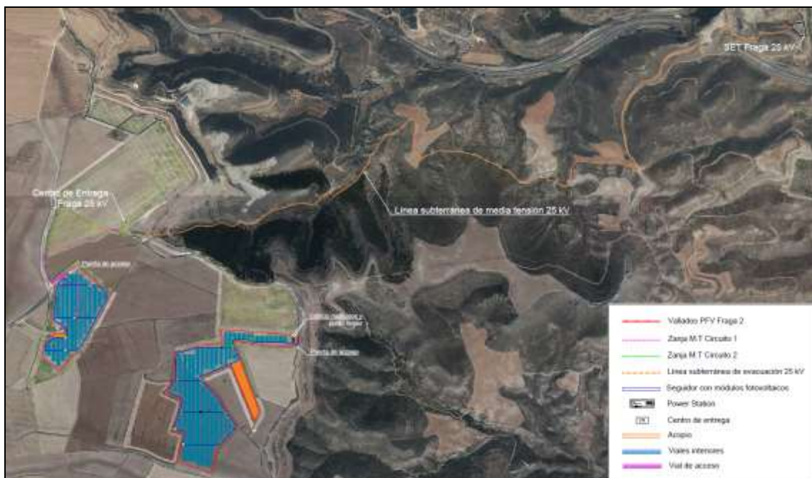
Figura 23. Línea subterránea de media tensión de PFV Fraga 2 a SET Fraga.
