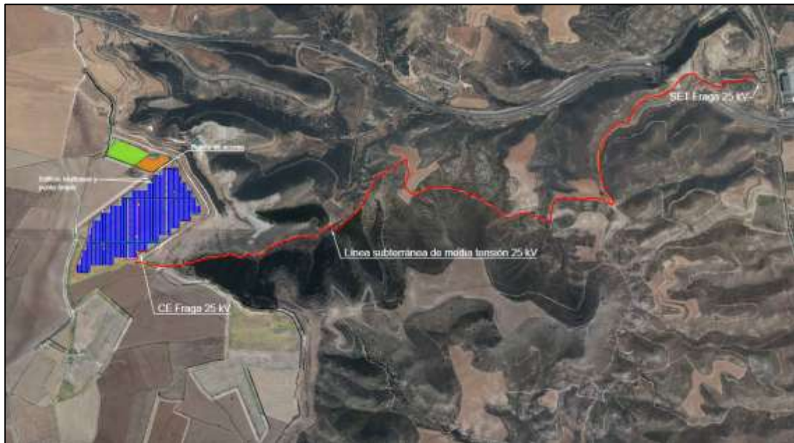
Figura 4. Línea subterránea de media tensión de PFV Fraga a SET Fraga.
