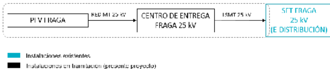
Ilustración 6: Infraestructuras de evacuación
