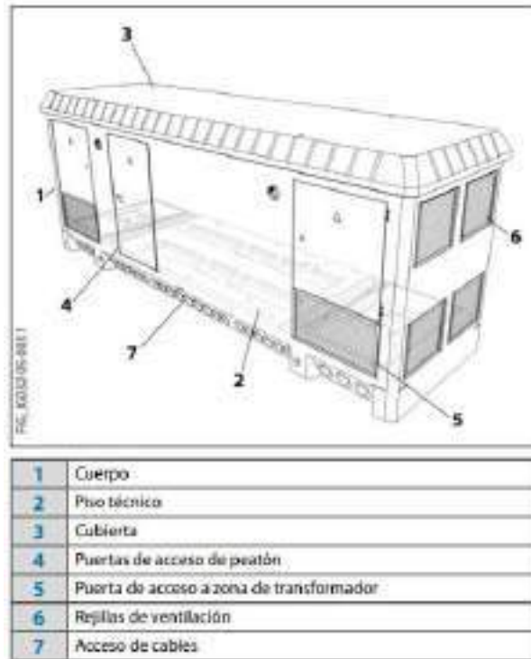
Ilustración 20. Elementos principales PFU. Fuente: ORMAZABAL
