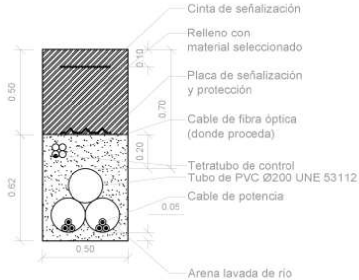
Ilustración. Zanja para tramo Entrada y Salida
